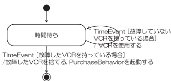
図 12 Consumer エージェントの UseVCRBehavior Fig. 12 UseVCRBehavior of Consumer Agent (statechart diagram).
