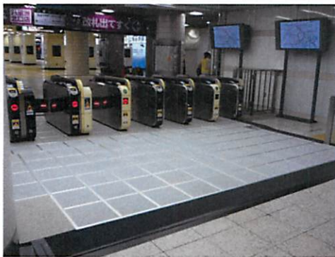
(d)2009年東京駅での床発電実験. 床発電総面積は25 m 2 . 1日平均940 kWの発電量.
