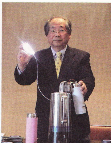
サーモエレクトリック・パワー・ジェネレーターは上部に手を当てると発電し、プロペラが回る(中)。写真左は開発した武藤佳恭教授
