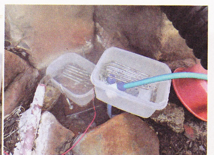
食品保存容器の中に温泉と水道水を通し、銅製パイプで熱を伝導する(右)。温度差に半導体素子が反応し、LEDランプが点灯した(中)
